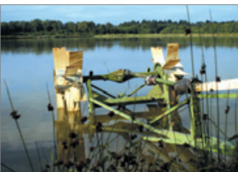
L'aérateur permet de brasser l'eau de l'étang pour une meilleure oxygénation durant la période estivale
